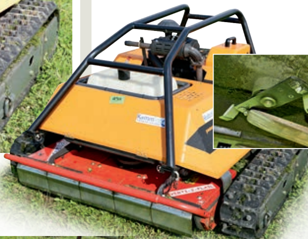
Drei verschiedene Mähdecks für ganz unterschiedliche Einsätze gibt es für den RoboFlail. Hier die Messer des ESM-Decks, das sich für groben, langen Aufwuchs eignet.
