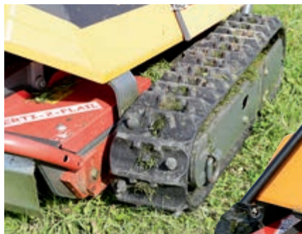
Die Laufwerke bestehen aus Gummigewebeband und haben spezielle Noppen, um sich besser mit dem Boden zu verzahnen.
